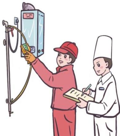
3. 应定期对燃气表、燃气具及燃气管道、连接软管等进行检查，可用发泡剂（如肥皂水）、检漏仪等方法查漏，严禁使用明火查漏。
