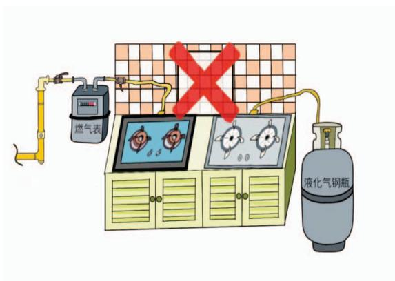
5. 燃气具连接软管可选用不锈钢波纹软管、金属包覆软管、橡胶复合软管，应标有产品名称、执行标准、有效使用期等基础信息，软管应在有效使用期限内使用。软管长度不应超过2米，中间不得有接头、三通，不得穿越墙体、门窗、顶棚和地面等。
